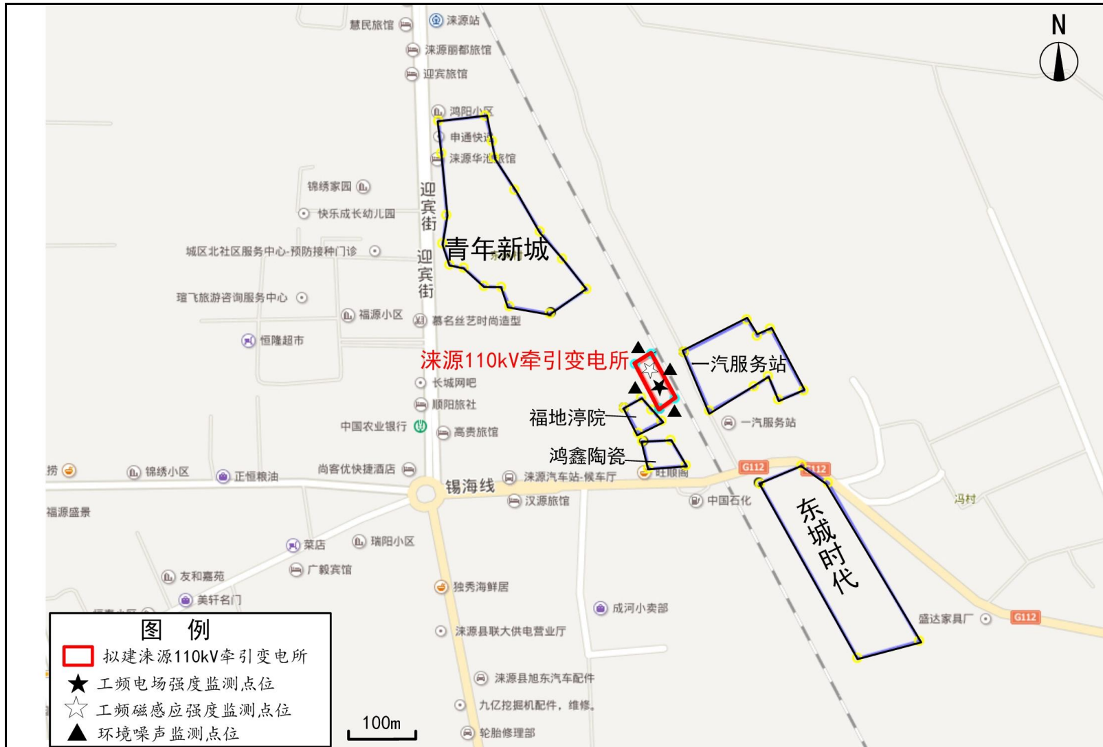
附图4 拟建涑源110kV变电所工频电磁场和噪声监测点分布示意图
