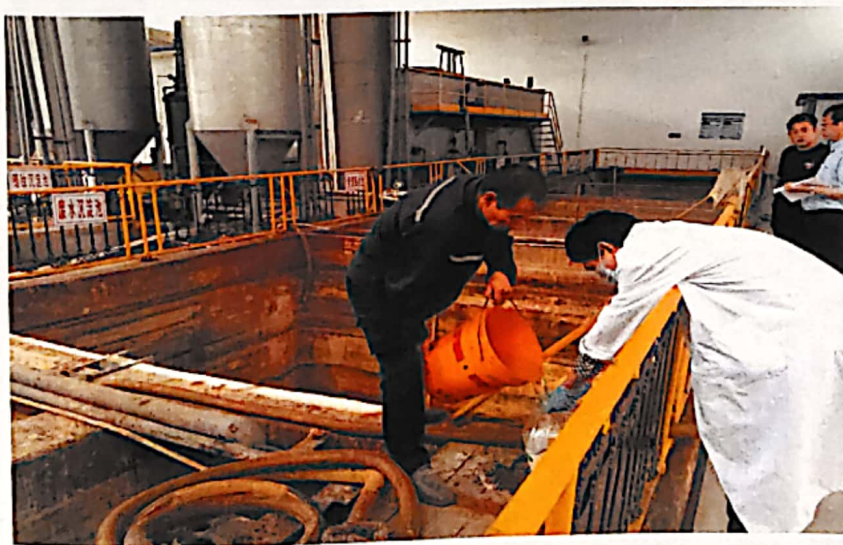
图 6.4.1 萃取回收池水现场取样
