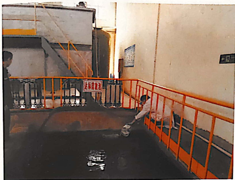
图 6.4.2 总排放口水样现场取样
