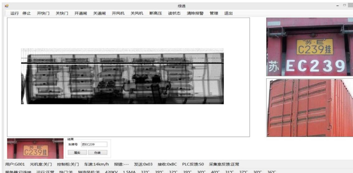
图 10 显示在计算机屏幕上的辐射投影图像
