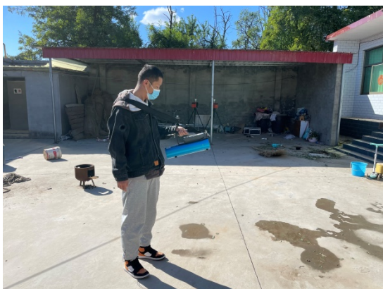
a.南辛村空气吸收剂量率现场监测
