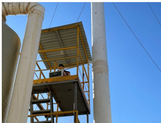
b. 锅炉废气排放口废气采样 (DA005)
