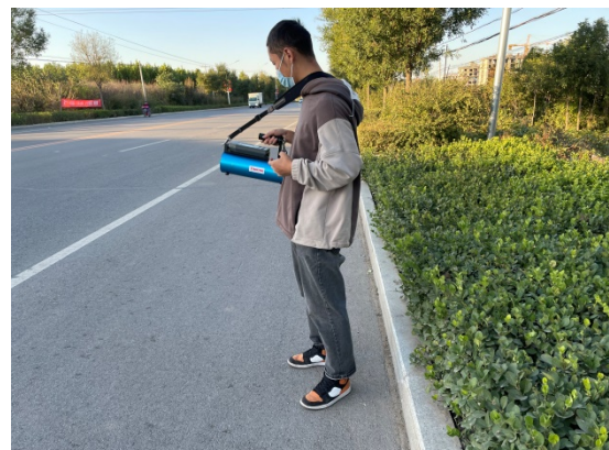
b.进出厂界公路空气吸收剂量率现场监测
