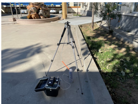
a. 厂区氡浓度、钍射气现场监测
