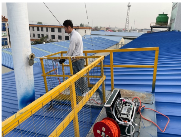
a.废气排放口采样 (DA004)
